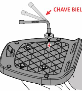
3 Insira 4 peças de plástico do kit nos pontos necessários junto com os parafusos para travar a base no suporte.
