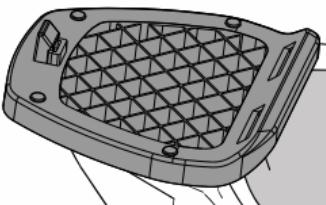
1 Retire a proteção de borracha da moto e os parafusos e identifique os pontos de travamento.
